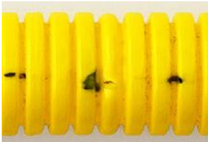
Obr. 13 Příklad plate – out efektu na PVC potrubí [24].
