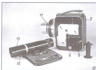
Spektareta - fotoaparát pro třibarevnou fotografii - jeden z prvních pokusů fotit barevně již v roce 1940
