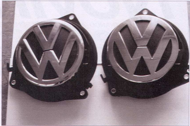
Schwenklem čili odjišťovací element pátých dveří je novým produktem ve výrobním sortimentu BRANO a.s. Určen je pro vozy koncernu Volkswagen
