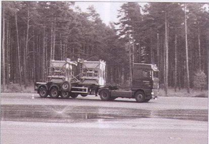
Návěs osazený zkušebními vzorky a měřicí aparaturou při zkouškách na polygonu
