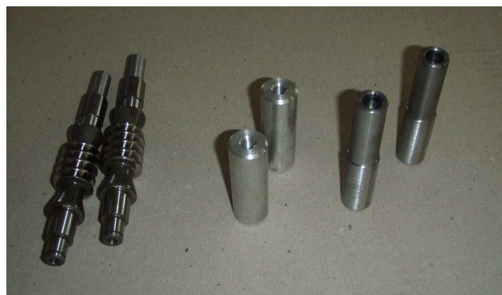
Zleva: 2 ocelové šneči, 2 duralové sloupky, 2 ocelové redukce
