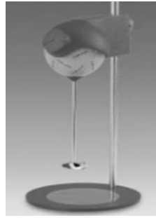
Obr. 39. Miešadlo v rozsahu otáčok 0-2000 ot/min [43].
