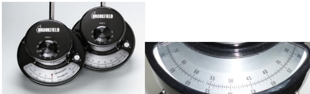
Obr. 38. Stupnica pre odpočet Viskozimetra BROOKFIELD [42].
