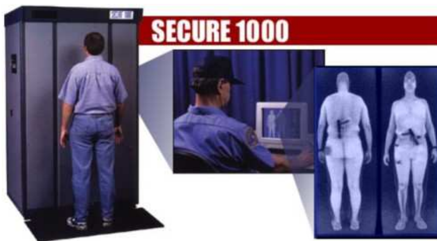
Obr. 24. Personální rentgen Rapiscan Securite 1000.
