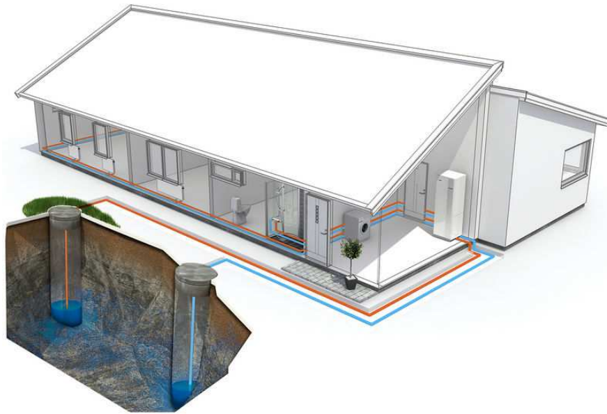
Obr. 4.6 Tepelné čerpadlo voda – voda s využitím studny
