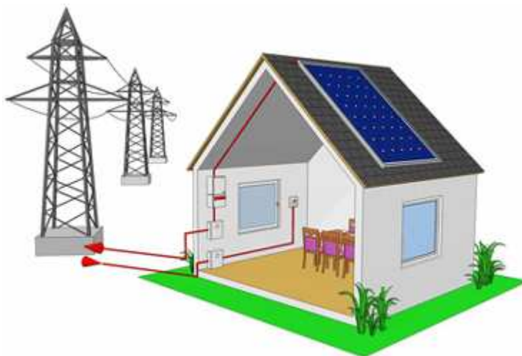
Obr. 9.1 Příklad systému grid-on
