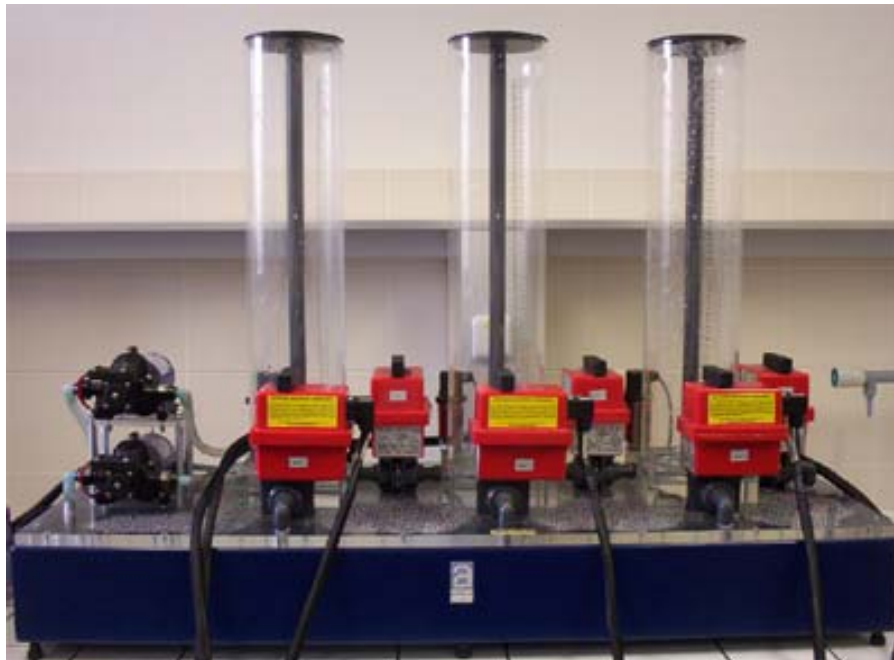
Obr. 1. Soustava tří spojených zásobníků DTS 200
