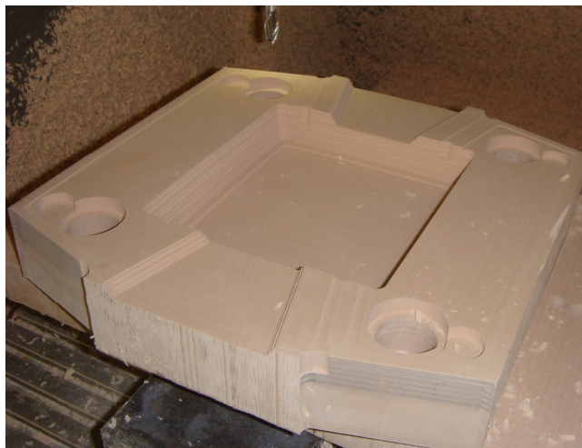
Obr. 91. Výroba dolnej dosky- po skončení operácie face milling area a cavity mill -10V
