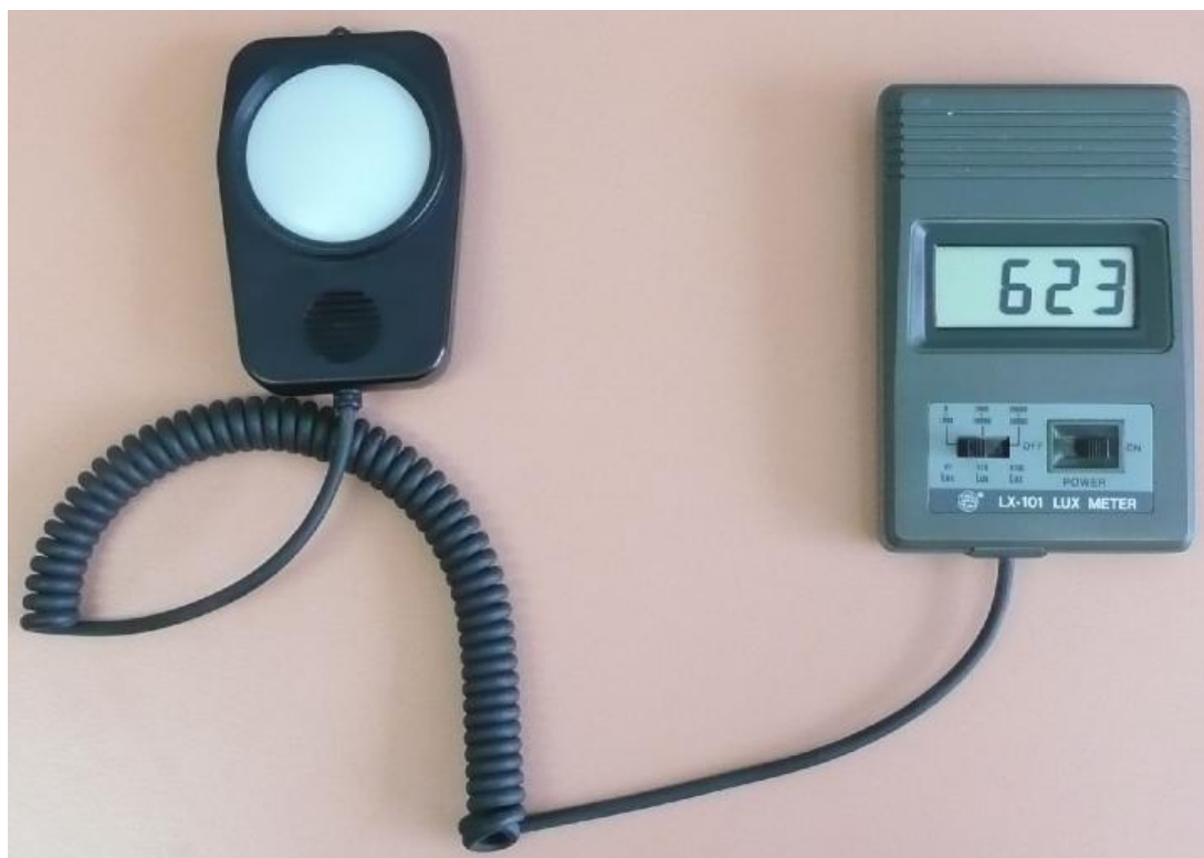
Obr. 10. Digitální luxmeter LX-101 [20]
