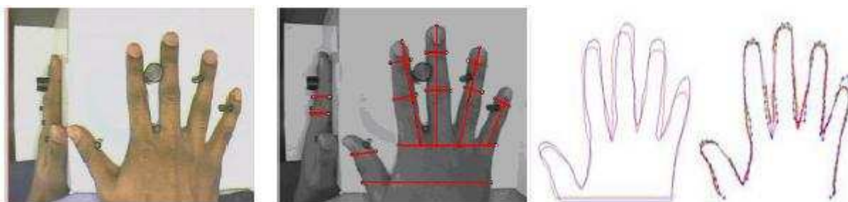
Obr. 35 Ruka se zrcadly snímána CCD kamerou a příklad měření vzdáleností
