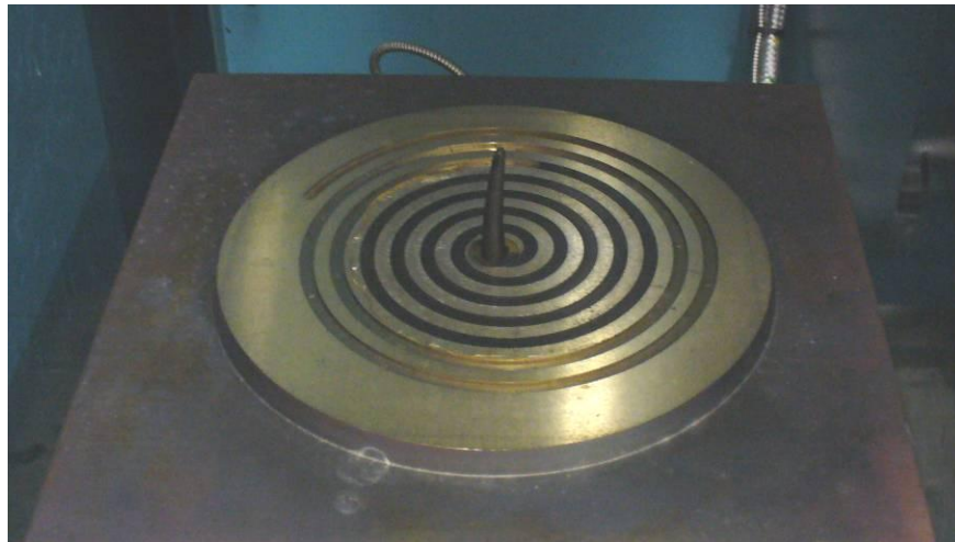
Obr. 26 Otevřená spirálová forma se vstříknutým vzorkem
