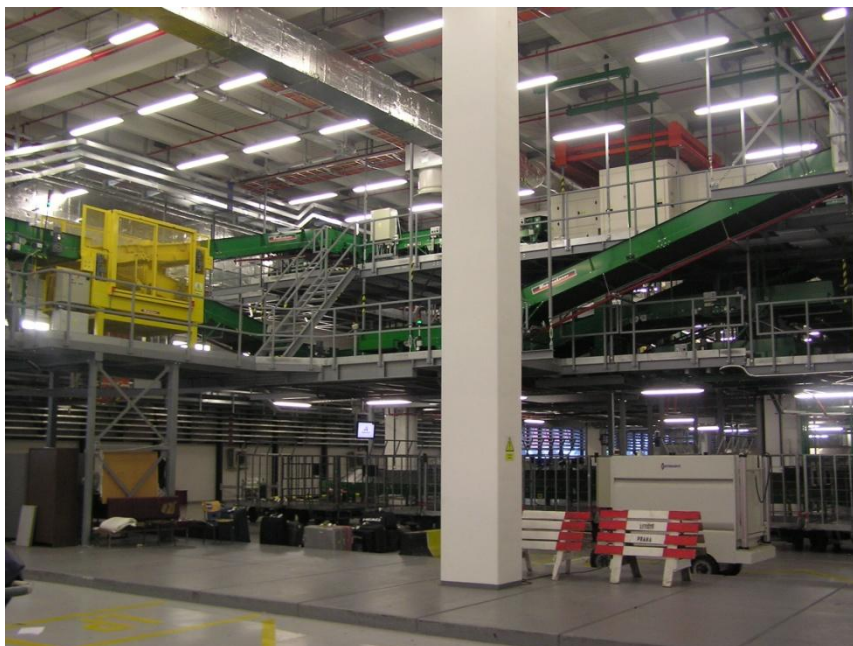
Obr. 7 Poloautomatický systém kontroly zapsaných zavazadel
