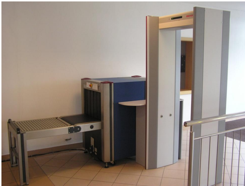
Obr. 3 Rámový detektor kovu s pásovým RTG detektorem
