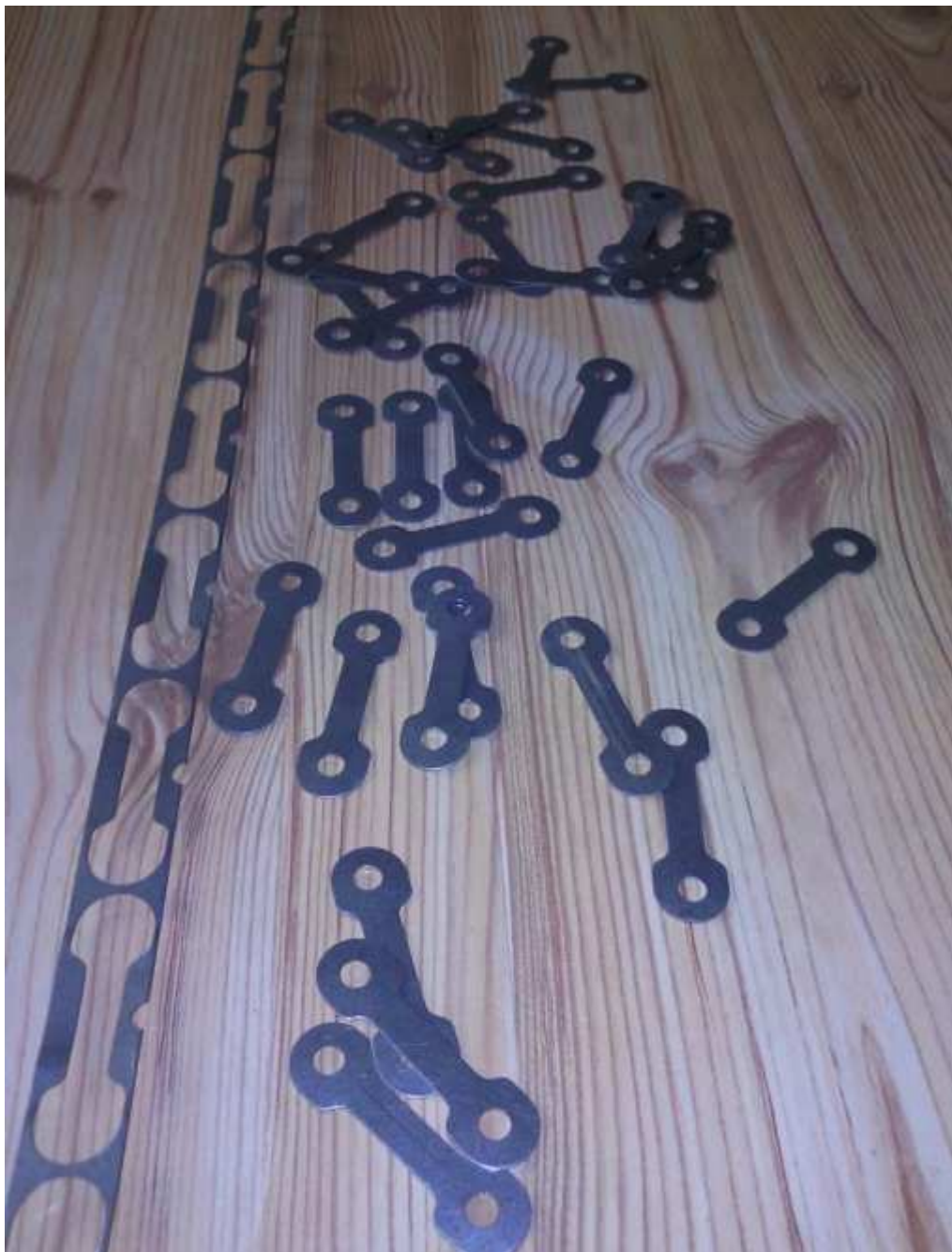
Obr. 64 výstřížky a technologický odpad (prostřížený pás plechu)
