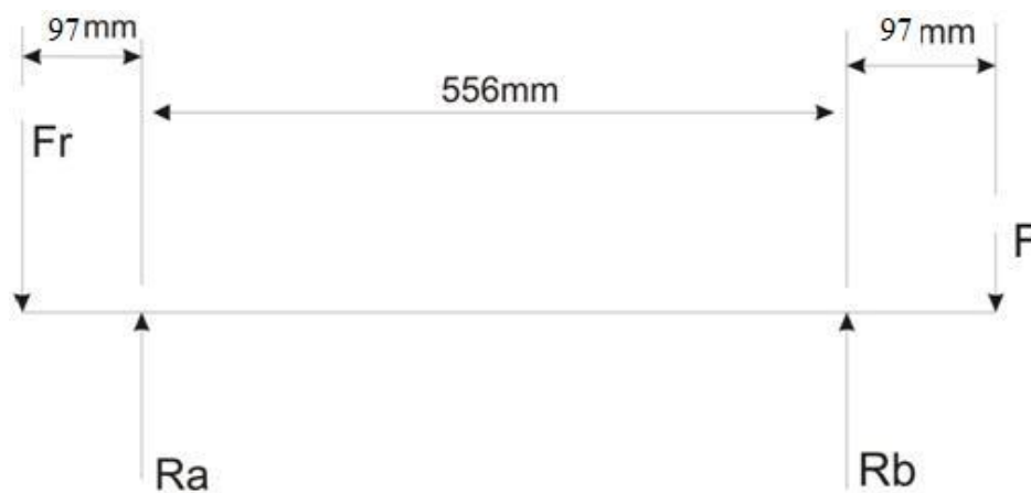
Obr.16 Vnější síly působící na vnitřní hřídel
