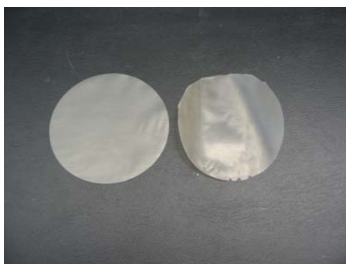
Obr.47. Změna barvy u vzorku PVC 47
