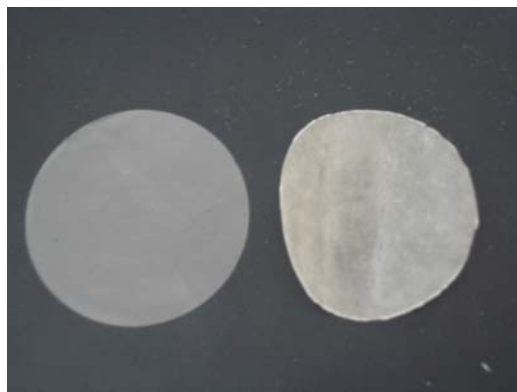
Obr.40. Změna barvy u vzorku PVC 47
