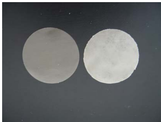
Obr.33. Změna barvy u vzorku PVC 45
