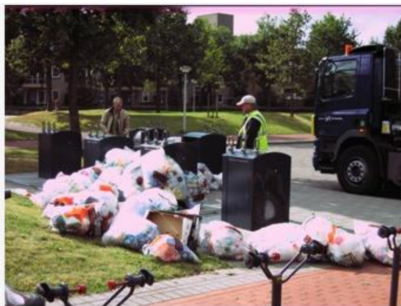
Obr. 25 – Malý vhozový otvor může znamenat problém při ukládání objemnějšího odpadu [32]
