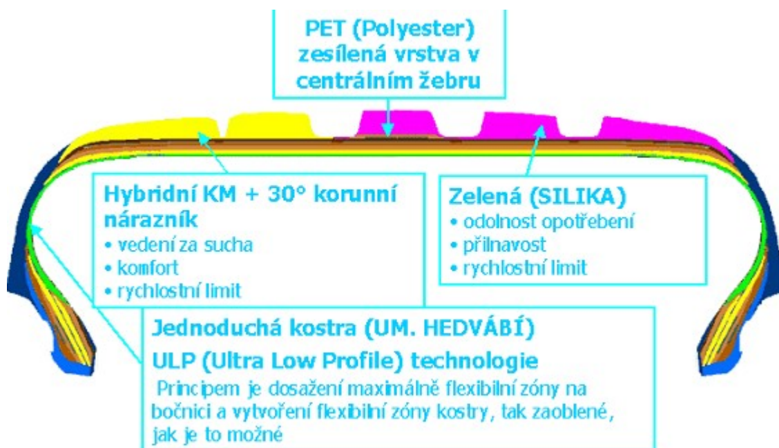
Obr.č.16 Složení pneumatiky [13]
