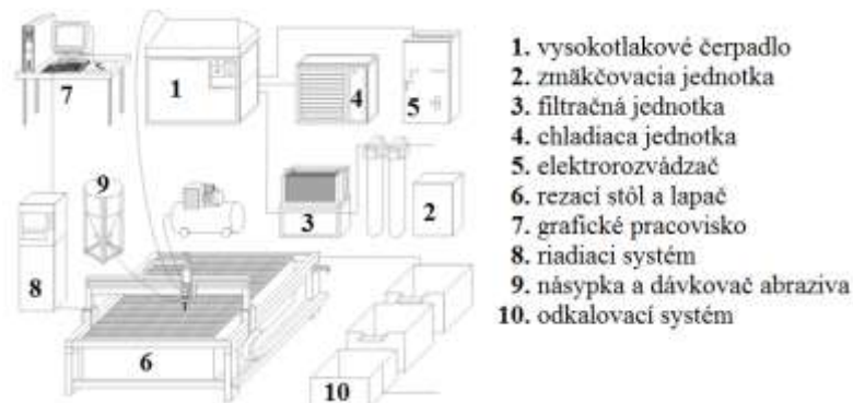
Obr. 19. Schéma prístroja na rezanie vodným lúčom
