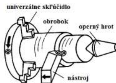
Obr. 2. Sústava stroj – nástroj - obrobok
