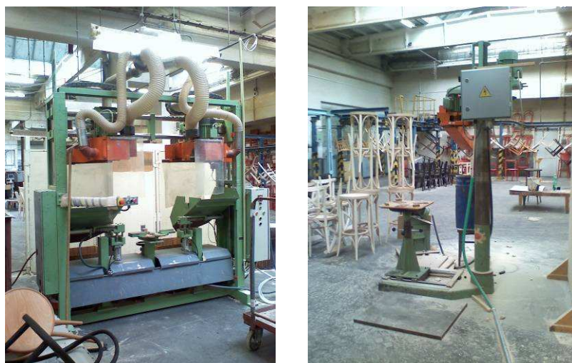
Obrázek 38 a 39 V současnosti používané stroje pro ořez nohou – vlevo automat, vpravo pila [34]
