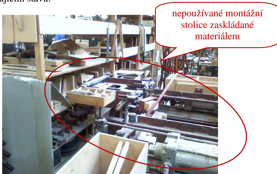
Obrázek 37 Montážní stolice pro výrobu židlí s kruhový průřezem PN [34]
