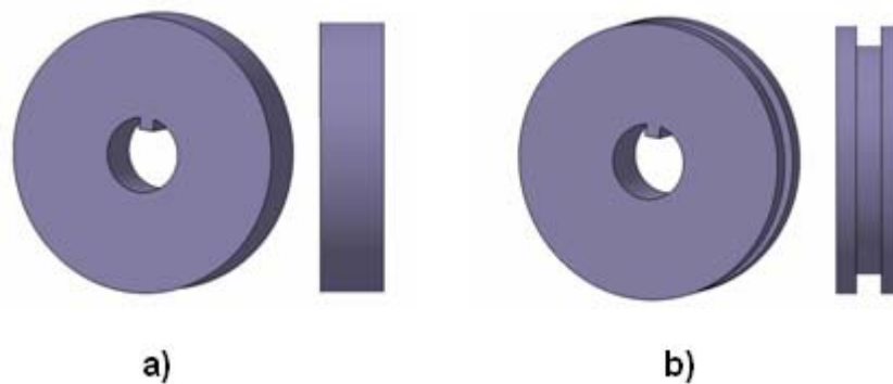
Obr. 26 Zkušební těleso pro zkoušku rychlého opotřebení [16]
