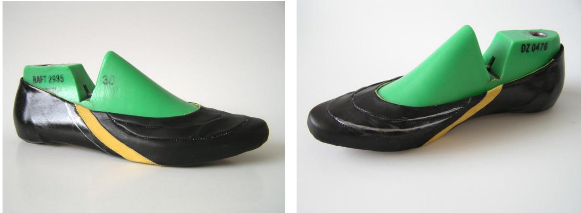
Obr. 43, 44: Zkouška modelu baleríny se zvýrazněnými chybnými liniemi
