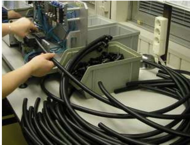
Obrázek 15 Montáž koncovky na dlouhou hadici [vlastní zpracování]
