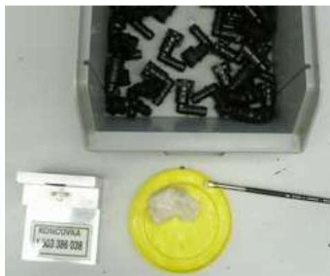
Obrázek 13 Montáž a mazání koncovek [vlastní zpracování]
