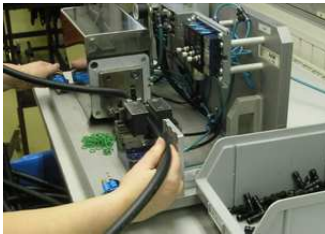
Obrázek 17 Kompletace hadicového systému [vlastní zpracování]
