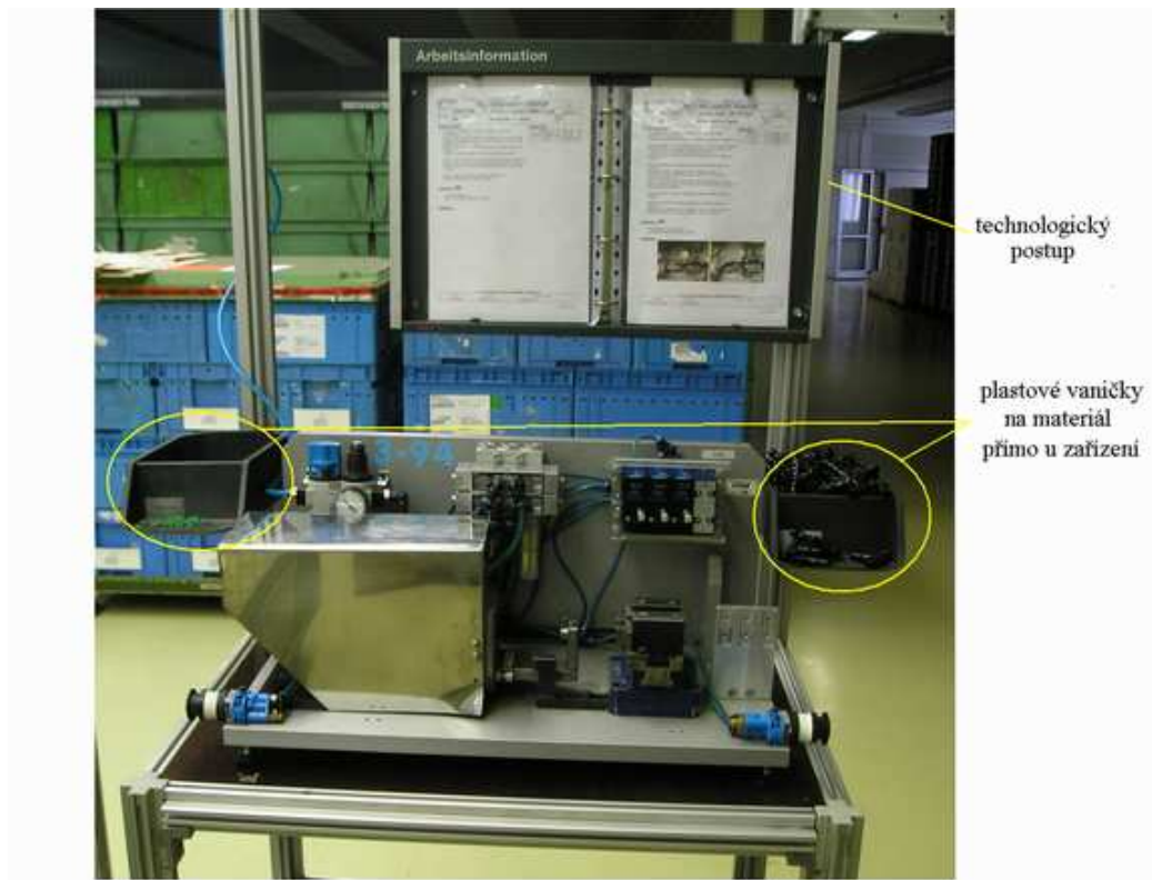
Obrázek 30 Detail nového pracovního stolu [vlastní zpracování]
