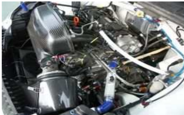
Obr. 18. Motor Škody Fabie S 2000 s karbonovým krytem [12]
