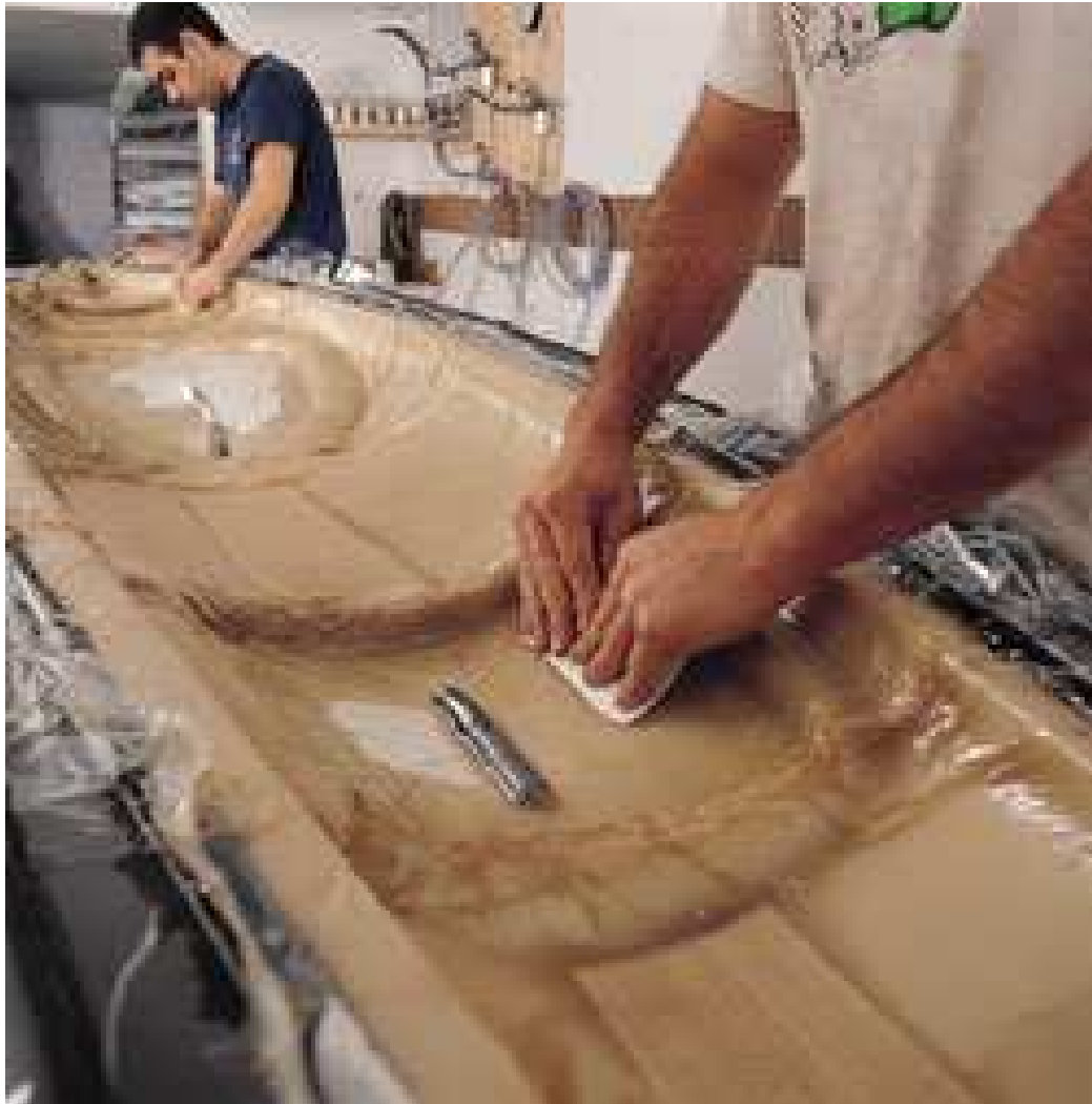
Obr. 15. Výroba kajaku technologií Vacuum bag moulding [10]
