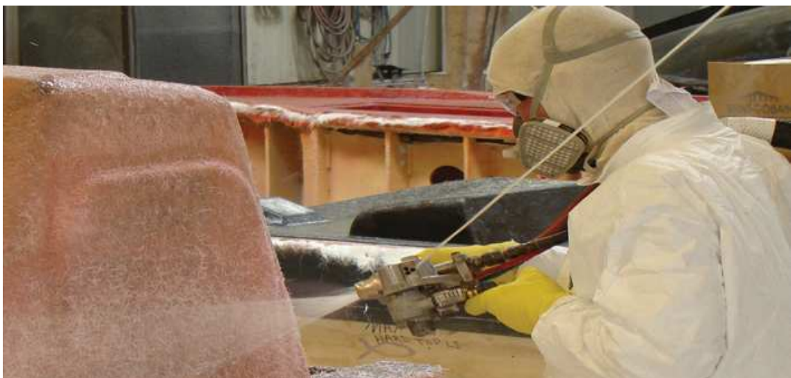
Obr. 22. Nástřik kompozitu na formu pro výrobu jachet [16]
