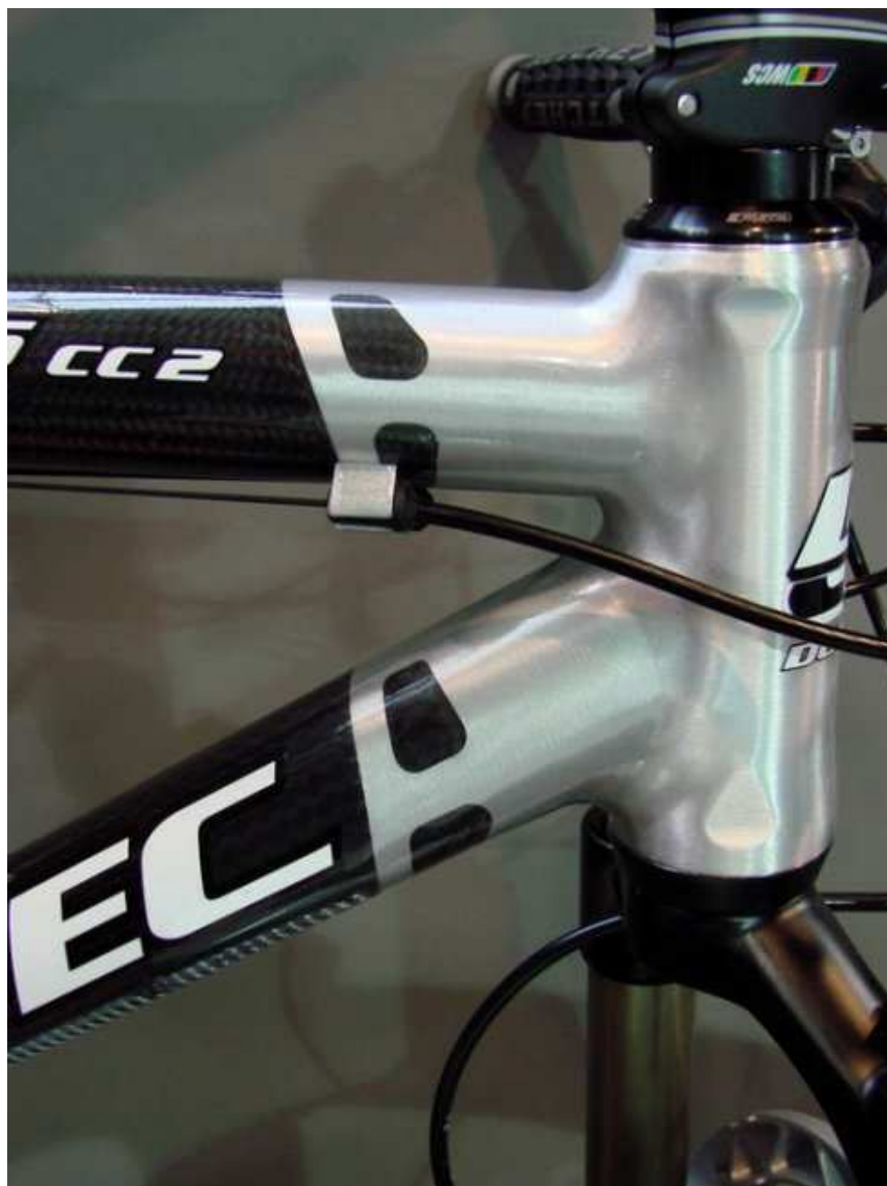
Obr. 30. Rám Duratec vyrobený technologií mechanického spojování kompozitu s durallem [23]
