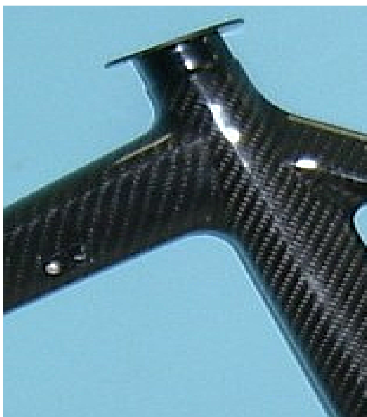
Obr. 32. Část rámu silničního kola vyrobeného technologií monocoque [25]
