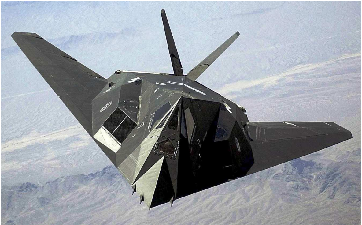
Obr. 33. Stíhací letoun stealth F117 US Army s kompozitním pláštěm [26]
