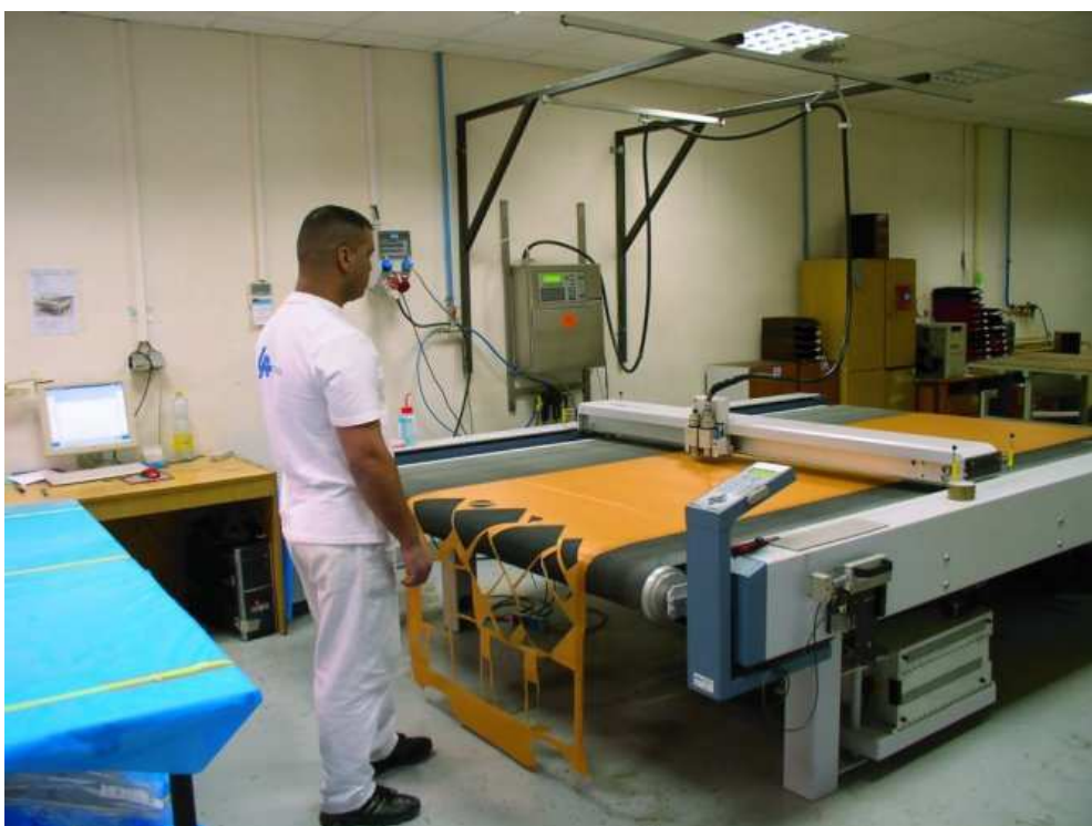
Obr. 6. Řezání prepregu plotrem [3]
