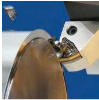
Obr. 5 Ukázka soustružení vyměnitelnou břitovou destičkou WNMG
