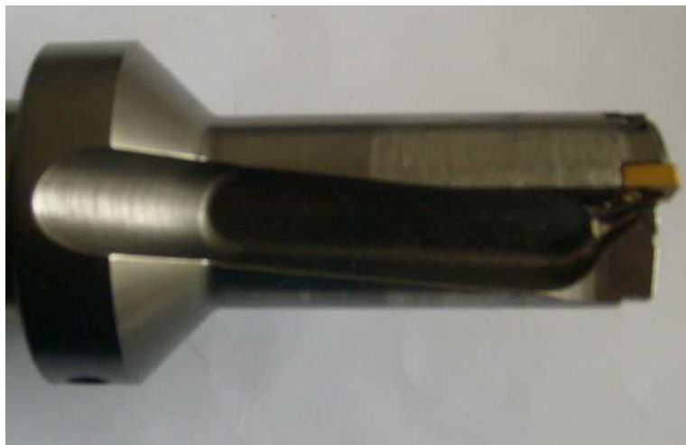
Obr. 18 Vrták 2D s vnitřním chlazením
