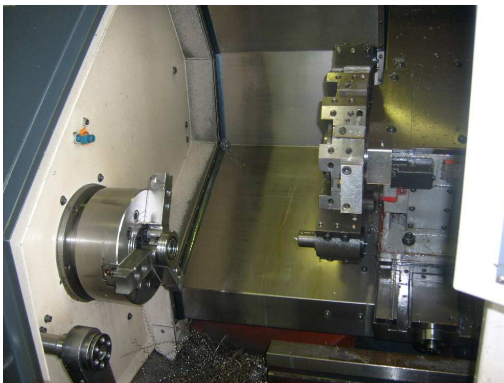
Obr. 23 Hotová horní zátka po obrobení na CNC soustruhu GOODWAY 2600
