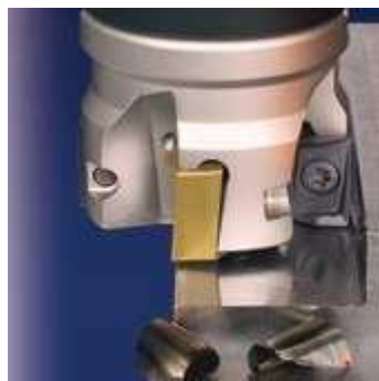
Obr. 6 Ukázka frézování nástrojem s vyměnitelnými břitovými destičkami
