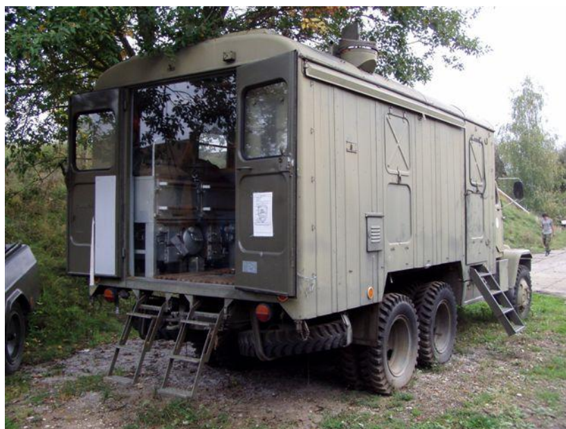
Obr. 3. Polní kuchyně POKA 3/1, na vozidle Praga v3s [16]
