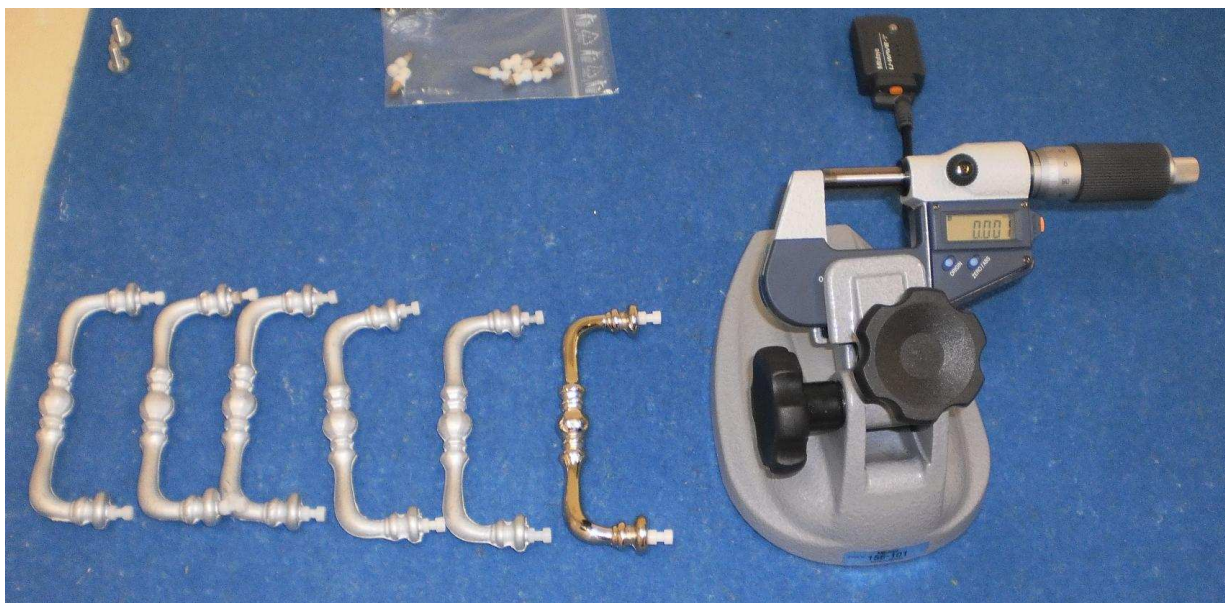
Obr. 36. Měření průměru jader mikrometrem Mitutoyo
