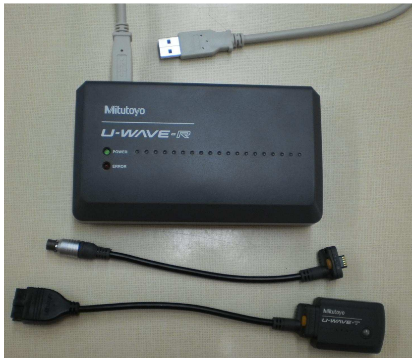
Obr. 35. Systém bezdrátového přenosu dat.
