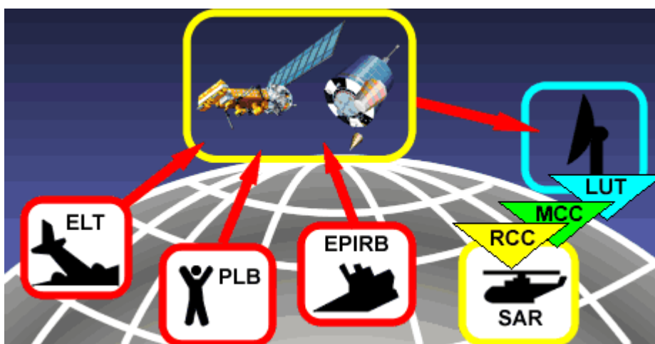
Obrázek 7: Schéma předávání zpráv v systému Cospas-Sarsat (19)
