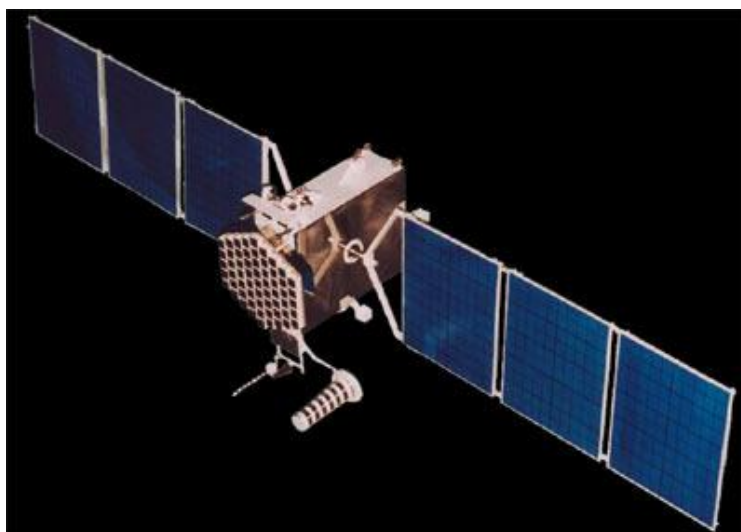
Obrázek 4: Družice Uragan-K1, kromě zařízení pro Glonass nese také zařízení pro systém Cospas-Sarsat (5)
