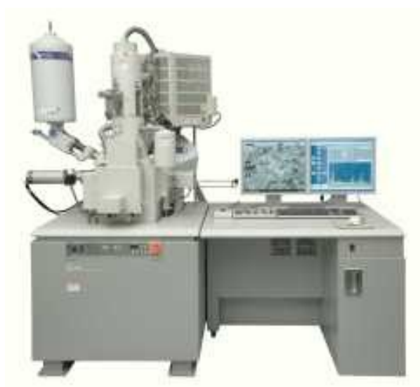
Obrázek 21 Rastrovací mikroskop SU-70 [22]
