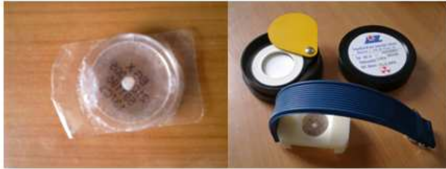
Obrázek 20. Radionuklid ^{137}\text{Cs} , pouzdro na uskladnění radionuklidu ^{137}\text{Cs} a pouzdro na připevnění k sondě LB 6360 po čas kalibrace
