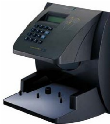
Obr. 18 Snímač geometrie ruky [18]
