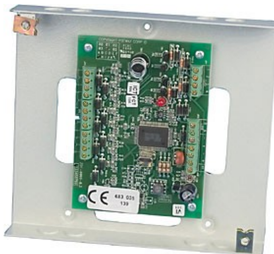
Obr. 34 G8 rozšiřující modul [29]
