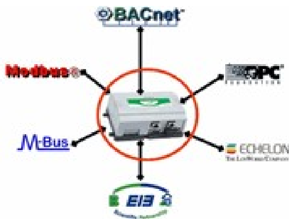
Obr. 22 Propojení komunikačních protokolů [22]
