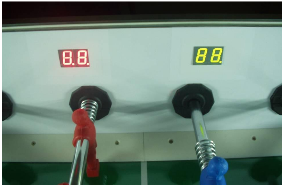
Obr. 24 Hotové oblepení displejů + zkouška funkčnosti.
