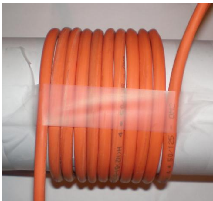
Obr. 26 Optický kabel s ohybem 10x průměr 7,5cm
