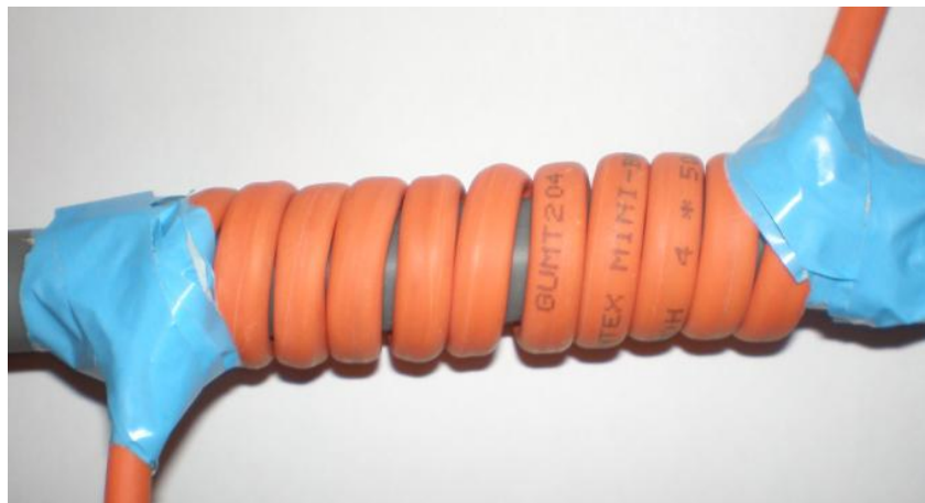
Obr. 28 Optický kabel s ohybem 10x průměr 1,5cm
