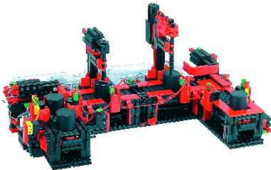
Obr. č. 9: Montážní linka s dvěma pracovišti
