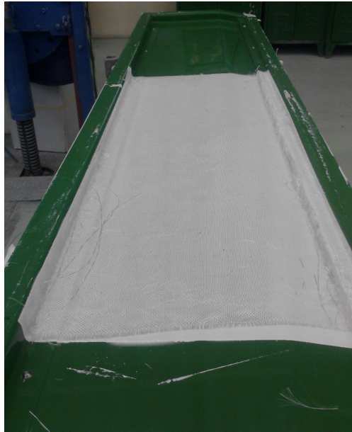
Obr. 48: První a druhá vrstva výztuže
