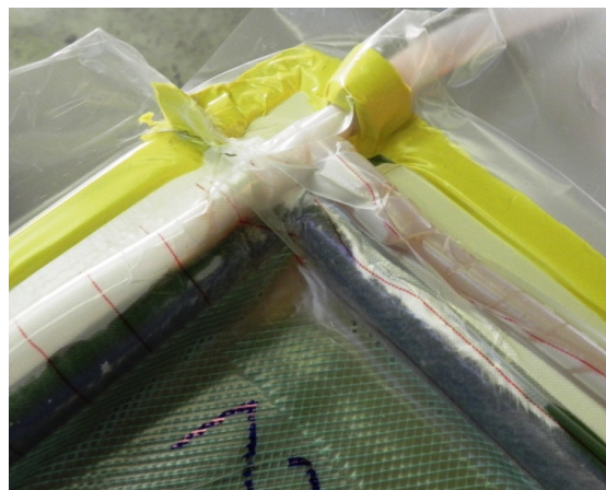
Obr. 72: Detail napojení na rezervoár „T“ kolínkem v rohu formy
