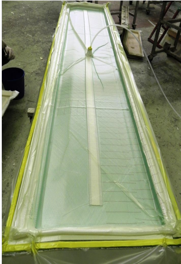
Obr. 71: Celkový pohled na zavakuovaný výrobek
