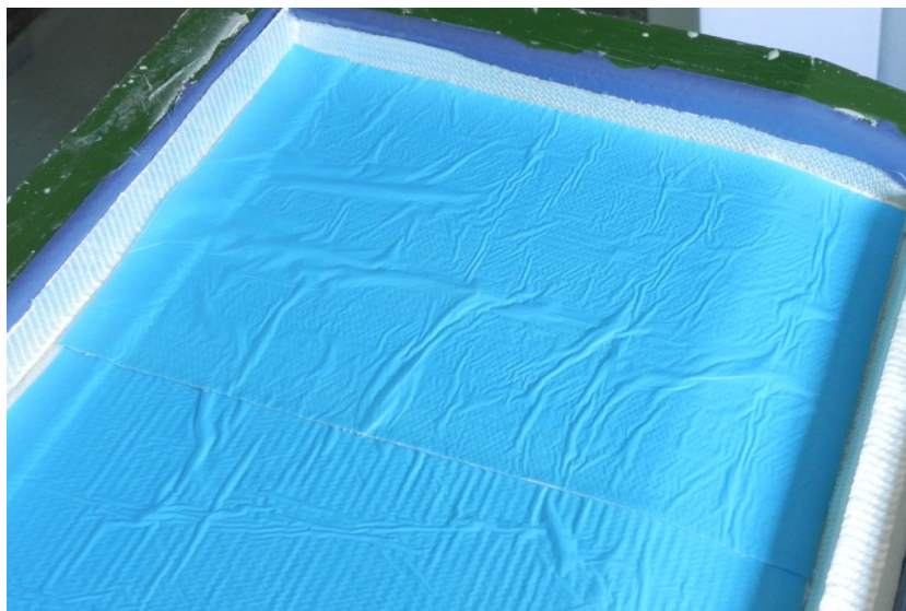
Obr. 82: Modrá střední část plochy výrobku položena po založení rohů
