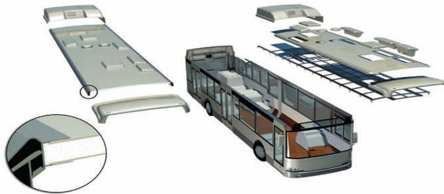
Obr. 14: Sendvičová struktura střechy autobusu[16]
