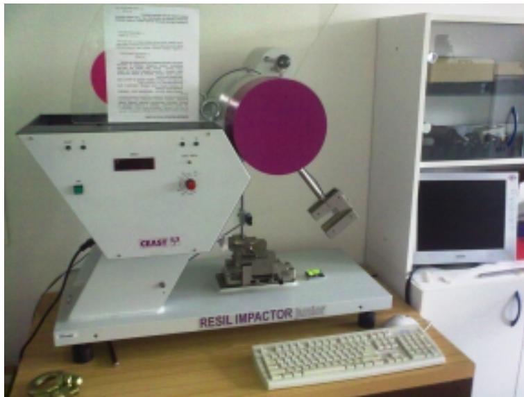
Obrázek 13 – Zkušební zařízení CEAST RESIL IMPACTOR junior
