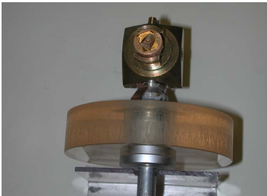
Obr. 40. Podavač vzorku umístěného na terčiku do vakuové komory SEM [23]
