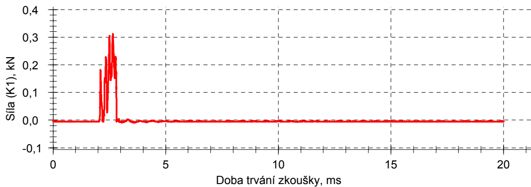
P 37: Křivka průměrných hodnot vrubové houževnatosti normalizovaných tělísek D – bez působení horkého dieselu
