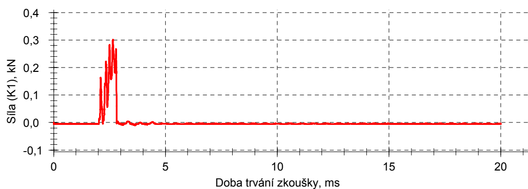
P 38: Křivka průměrných hodnot vrubové houževnatosti normalizovaných tělísek E – bez působení horkého dieselu
