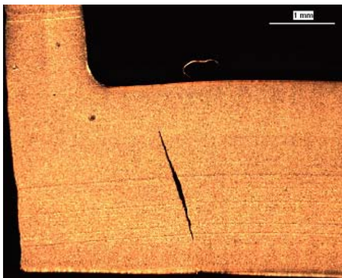
Obr. 15. Skrytá vada materiálu „prasklina“ vlivem mechanického namáhání – tenký řez 7 \mu\text{m} , polarizované světlo [1]
