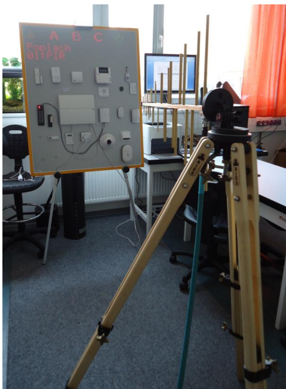
Obr. 25 Měření odolnosti systému OASIS, JA-80.
