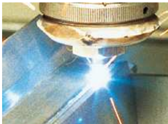
Obr. 9 Paprsek laserového svařování [7]
