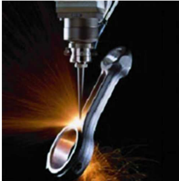
Obr. 7 Pohled do pracovního prostoru během vrtání laserem [7]
