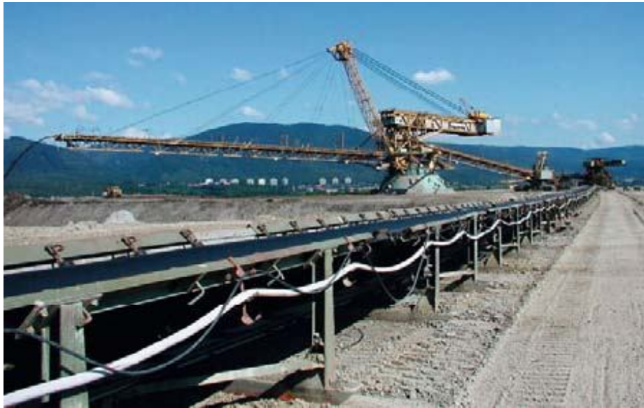
Obr. 5. Přeprava uhlí pásovým dopravníkem (elektrárna Prunéřov) [3]
