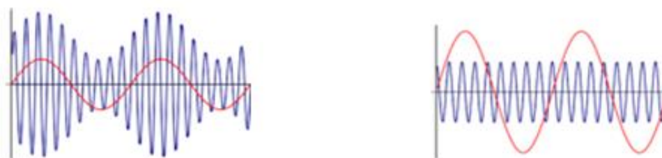
obrázek č. 14: Časový průběh plné AM a AM SSB s potlačenou nosnou
