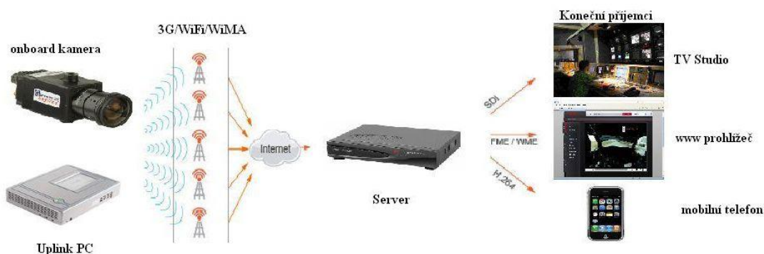
obrázek č. 29: Schéma přenosu mobilní sítě třetí generace
