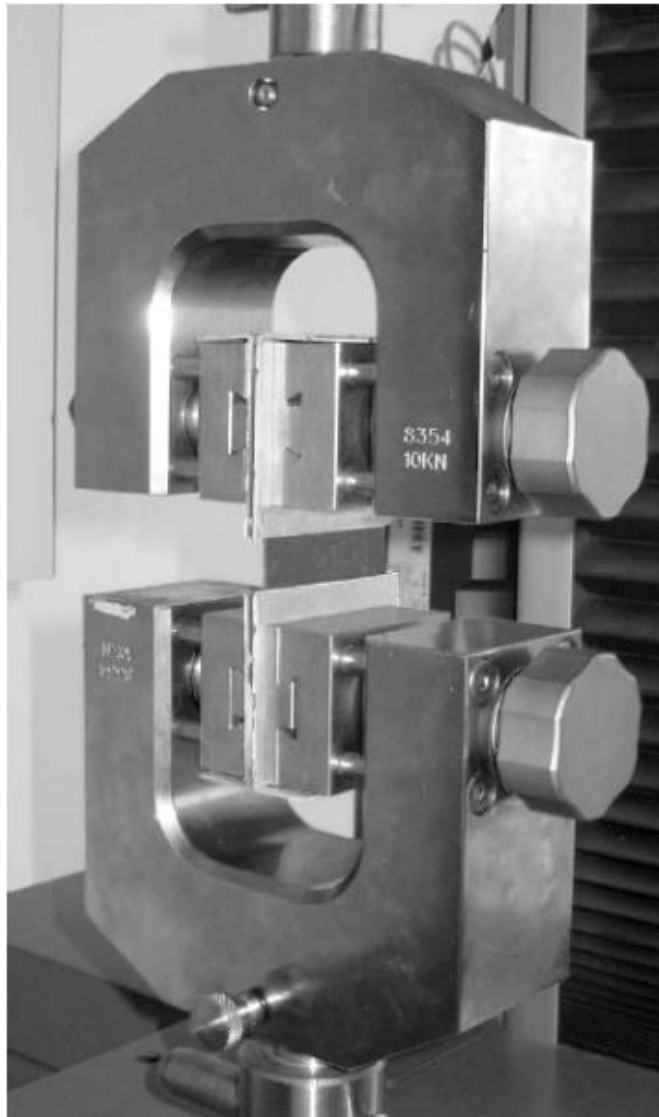
Obr. 17. Upínací zařízení pro čistý smyk [13]
