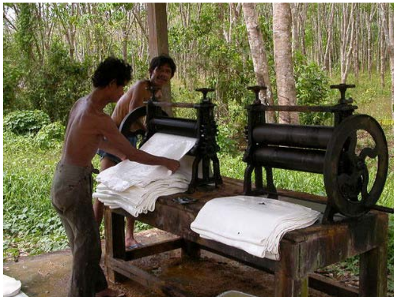
Obrázek 57 Současná kaučuková plantáž III - přidáním kyseliny mravenčí a vody se přírodní kaučuk sráží a vzniká tzv. krepa, jež se dále zpracovává [33]
