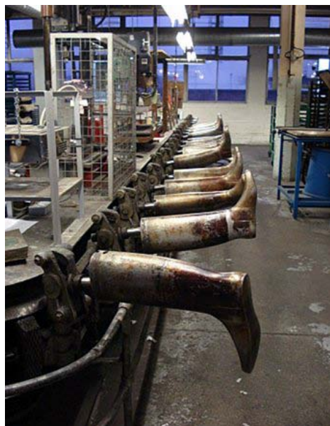
Obrázek 92 Výroba gumáků – před a po finální a povrchové úpravě [8]
