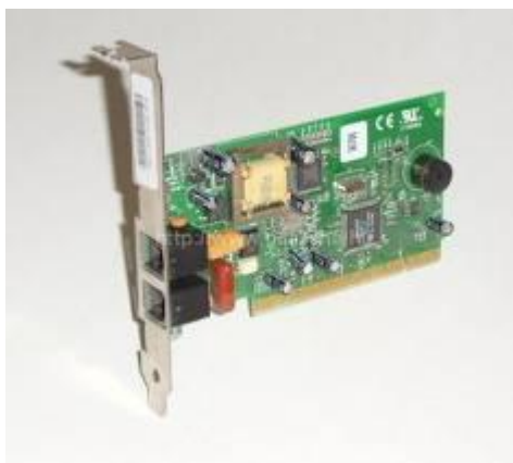
Obr. 6: Modem pro připojení k tel. síti
