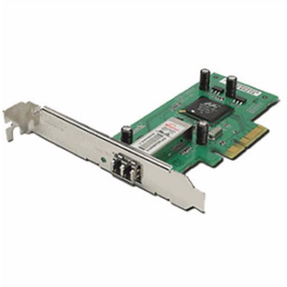
Obr. 11: Síťová karta s optickým konektorem D-link
