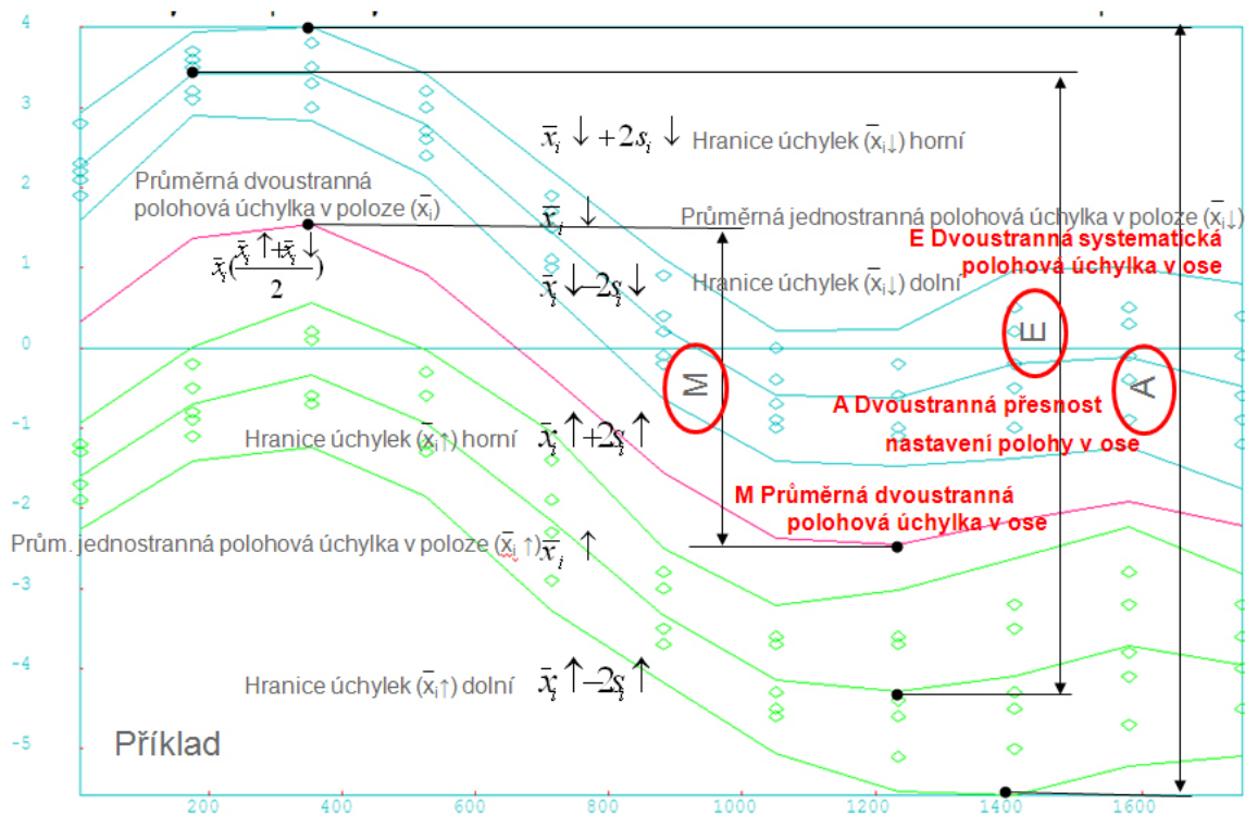
Obr. 19. Diagram průměrné dvostranné polohové úchylky v ose, dvostranné přesnosti nastavení polohy v ose a dvostranné systematické polohové úchylky v ose
