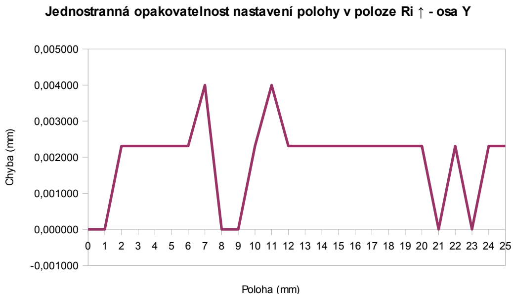
Obr. 73. Jednostranná opakovatelnost nastavení polohy v poloze Ri ↑ - osa Y
