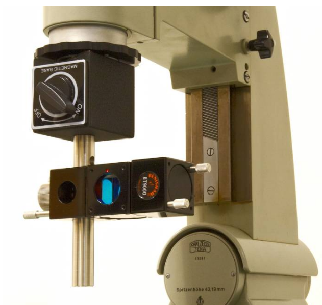
Obr. 45. Způsob upnutí laserového interferometru na mikroskop
