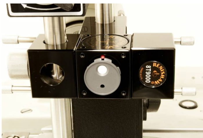
Obr. 51. Zaměření paprsku na lineární odražeč
