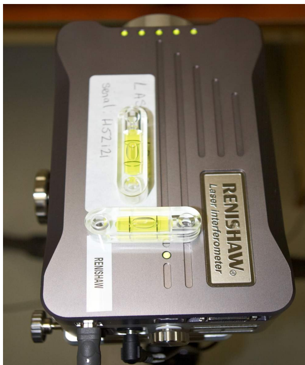
Obr. 44. Ustavení laserového interferometru do roviny
