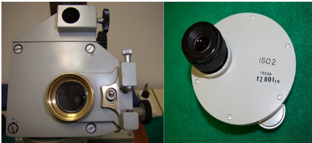
Obr. 77. Způsob uchycení okuláru na mosaznou objímku mikroskopu
