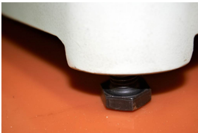
Obr. 43. Stavitelný šroub podstavy mikroskopu
