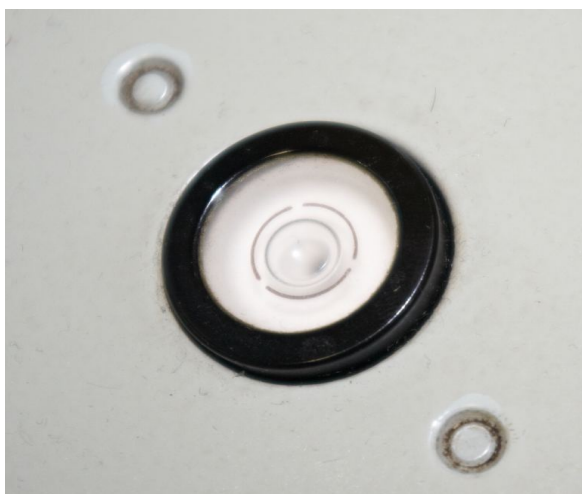
Obr. 42. Vestavěná libela na mikroskopu, tzv. "Býčí oko"
