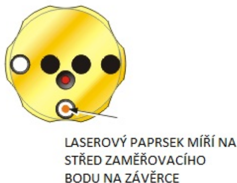
Obr. 52. Vracený paprsek lineárního odražeče [8]
