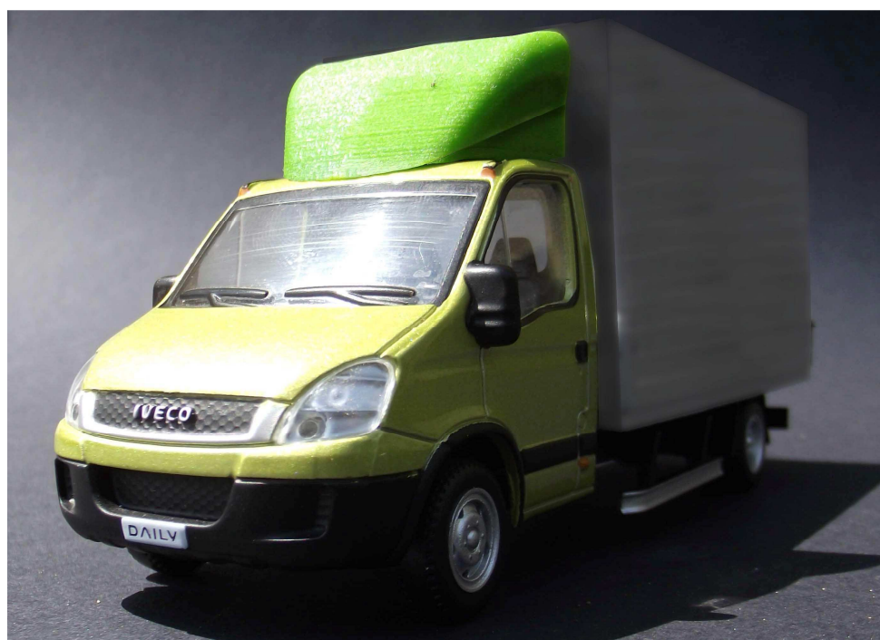
Obr. 48. model v mierke 1:43 – vizualizácia spojleru na aute s nadstavbou
