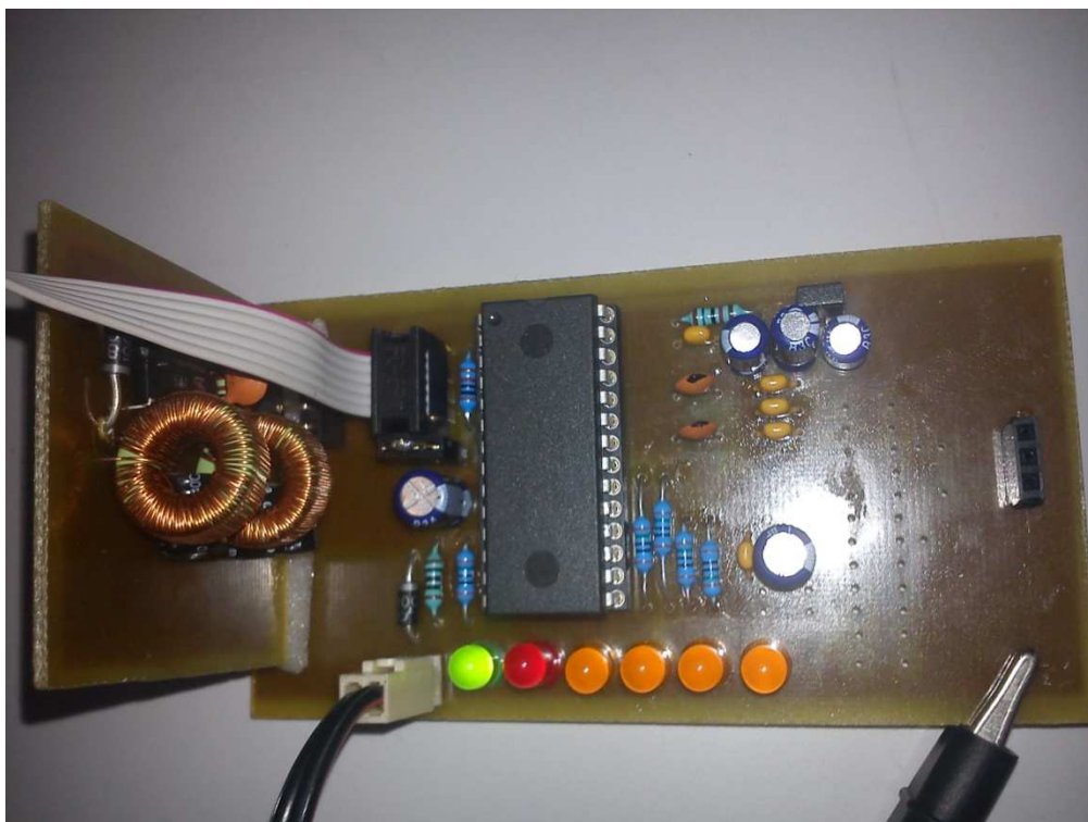
Příloha 11: Osazený KIT se spínaným stabilizátorem při ladění v laboratoři
