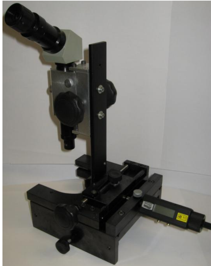
Obr. 24. Kompletně sestavený pojízdný stůl
