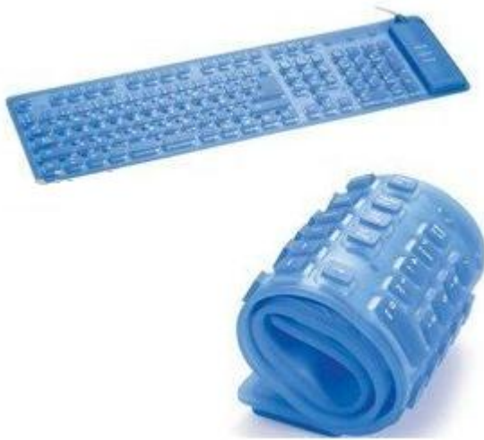
Obr. 14 Aplikace vodivých polymerů plastová klávesnice smotaná do ruličky [28].
