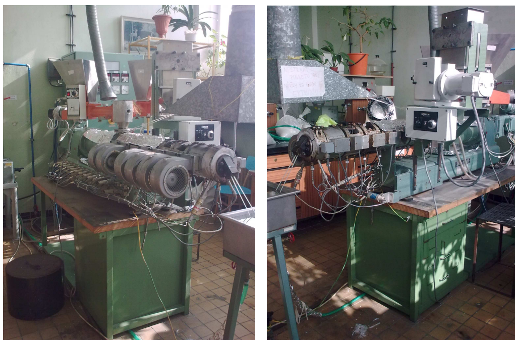
Obr. 29: Dvoušnekový extruder – homogenizace granulátu polymeru s plnivem
