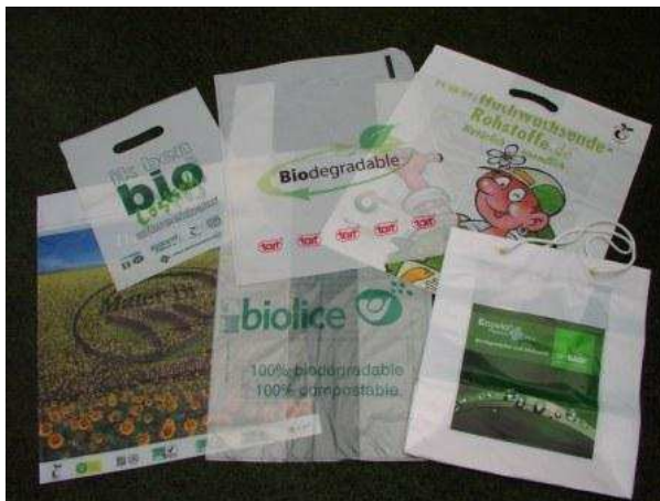
Obr. 18: Koextrudované fólie vyrobené z biopolymerů [34]
