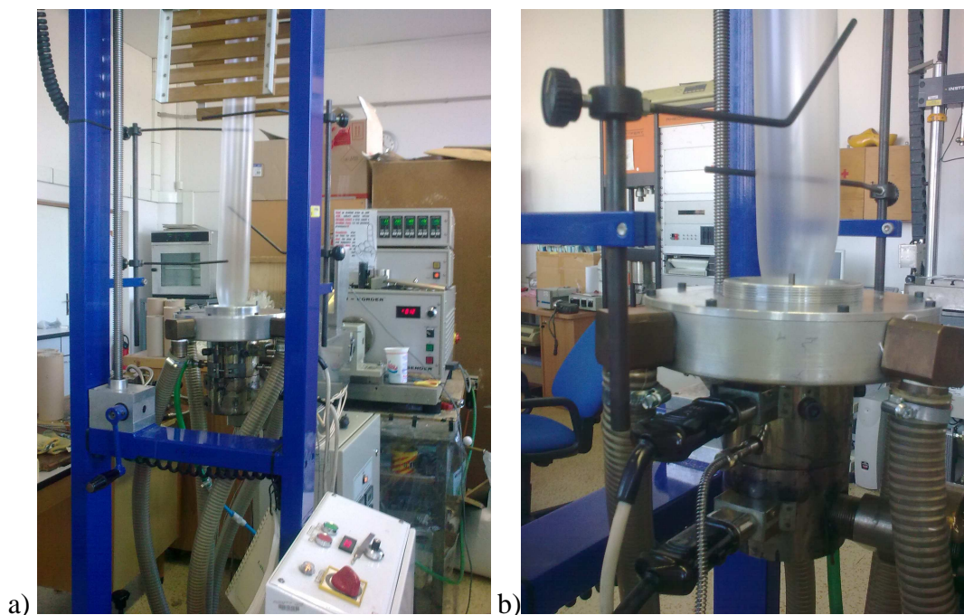
Obr. 31: a) Vytlačovací jednošnek a laboratorní vyfukovací linka, b) vyfouknutý rukáv
