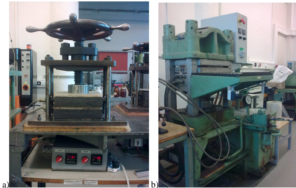
Obr. 30: a) Mechanický lis, b) hydraulický lis
