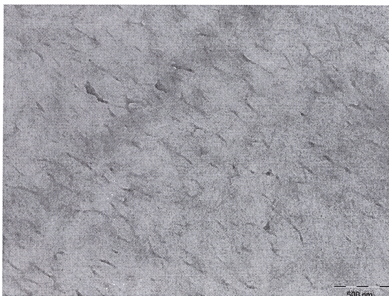
Obr. 17: TEM – mikroskopie PLA s 1hm% celulóзовých nanovláken [31]
