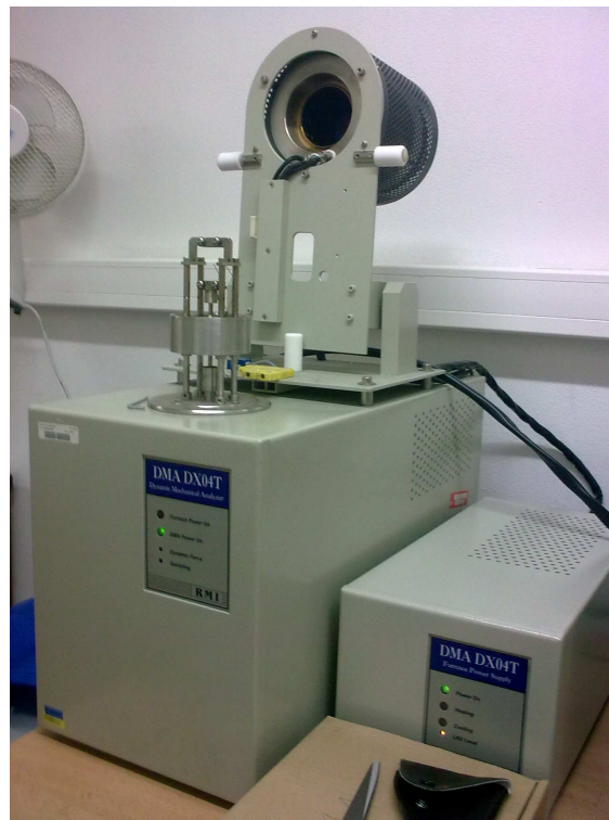
Obr. 38: Přístroj pro měření DMA
