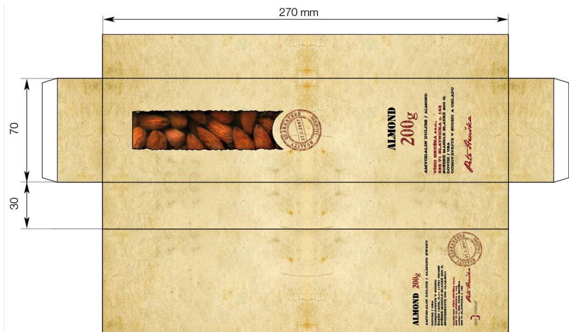
Obr. 64: Technický náčrt s grafickým potiskem
